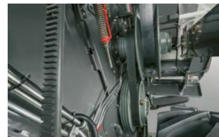
Batör 2 farklı devir hızına kolayca ayarlanabilir.
