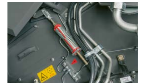
Tüm yağlama noktaları yağlama merkezinde birleştirilmiş ve açıkça etiketlenmiştir.
