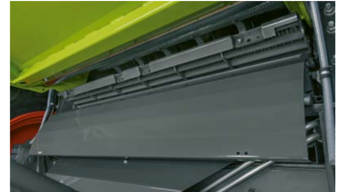
Kontra, taş tutucu ile birlikte kolayca yerinden çıkarılabilir.
